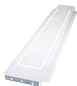
K871T Élément porteur secondaire pour structure croisée avec prédécoupe ; rectangulaire réalisée en usine pour l'installation d'appareils d'éclairage. Panneau 150x1 050mm. Prédécoupe rectangulaire 110x880 mm
