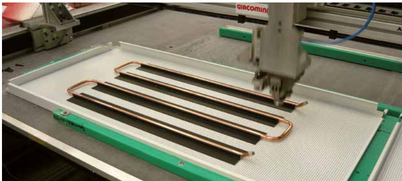
fig. 1.19 Assemblage en usine des panneaux rayonnants
