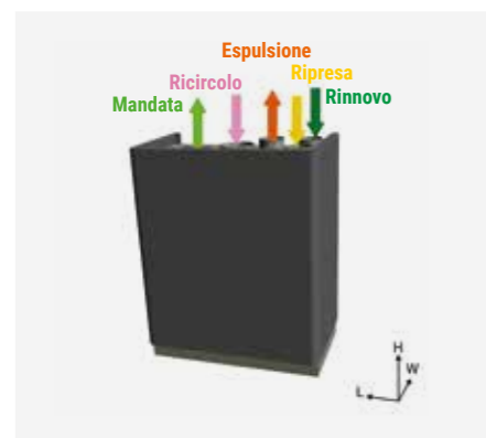
CONFIGURAZIONE FLUSSI ARIA UNITÀ VENTILATE
